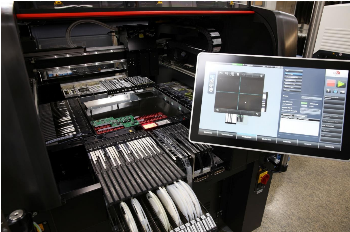
Bild 2: Die «Puma» als Insellösung bei KUBEG AG, aufgerüstet als High Flex Maschine mit 280 Feederplätzen, 18'800 Be/h IPC und einer Leiterplattengrösse von 560mmx610mm
