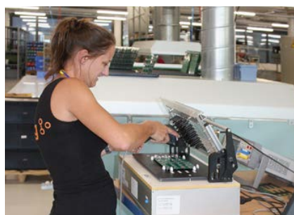
Die junge Dame unterzieht die Elektronikteile einer ganz genauen Kontrolle. Fehlerhafte Teile werden markiert und anschliessend in Ordnung gebracht.
